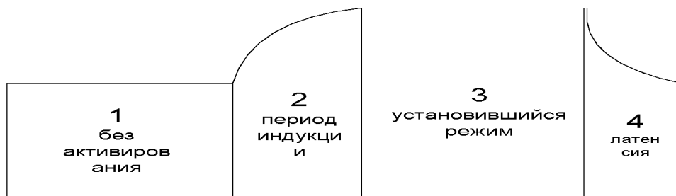
Рисунок 3.1 - Схема процесса механохимикоактивации при измельчении (степень разупрочнения)
