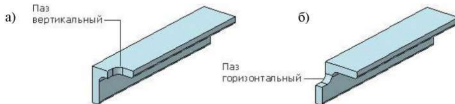
Рисунок 2.32. Примеры построения паза на профиле: а) в направлении вертикального ребра сечения, б) в направлении горизонтального ребра сечения
