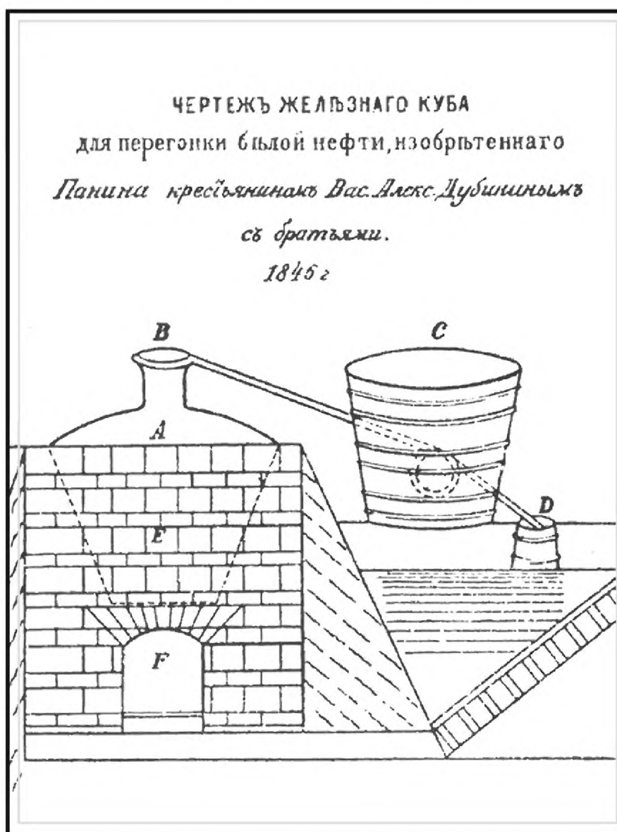
Рис. 4. Фрагмент чертежа железного куба для перегонки нефти братьев Дубининых.
