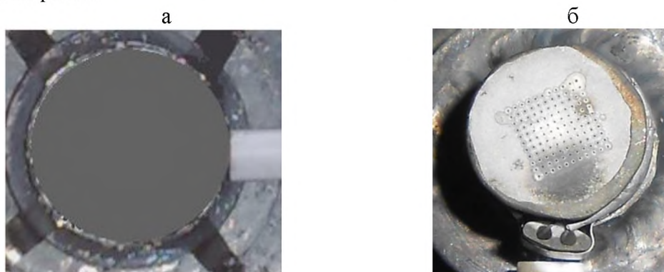
Рис.6. Внешний вид узла коллектора: а –после нанесения аморфного мелкодисперсного углерода (до продувки отверстий перфорации); б –после экспериментов в ТЭП (длительностью ~1000 час) с КВС цезия.
