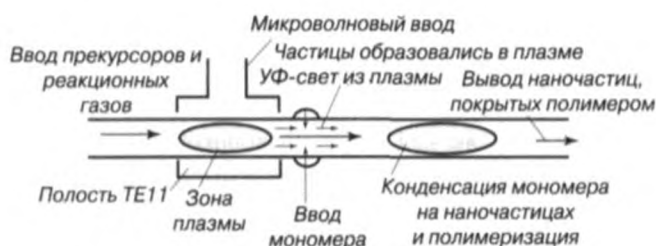
Рис. 3. Устройство для непрерывного получения наночастиц, покрытых полимерной пленкой
