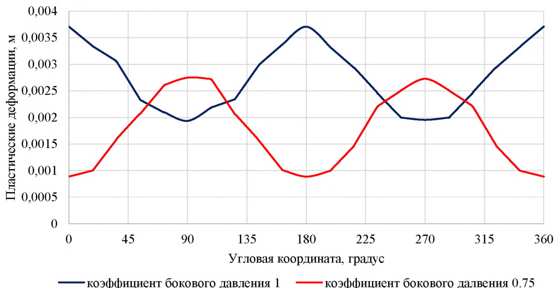
Рисунок 5.1.5 – Изменение величины пластических деформаций на контуре тоннеля с различными соотношениями вертикального и бокового давлений, при глубине заложения тоннеля 50 м
