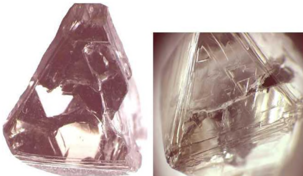
Рис. 3.7. Кристалл алмаза до обработки (а) и после обработки анолитом с pH ~2–3 (б)
