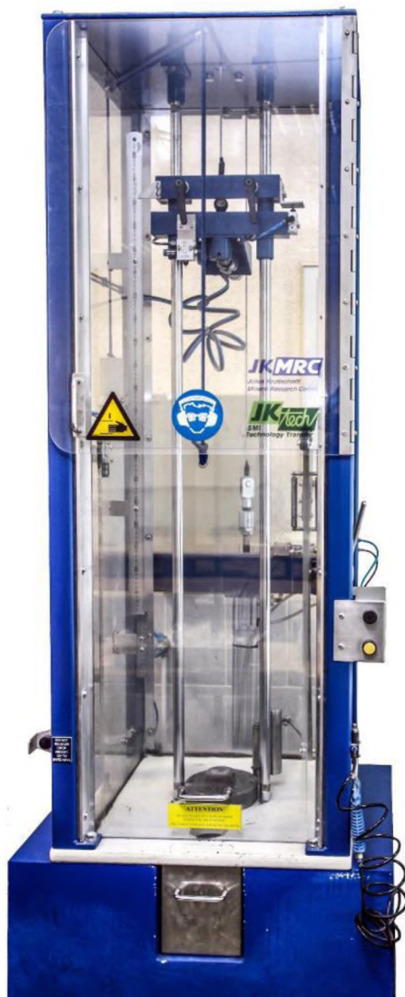
Рис.3.9. Схема устройства тестера падающего груза
