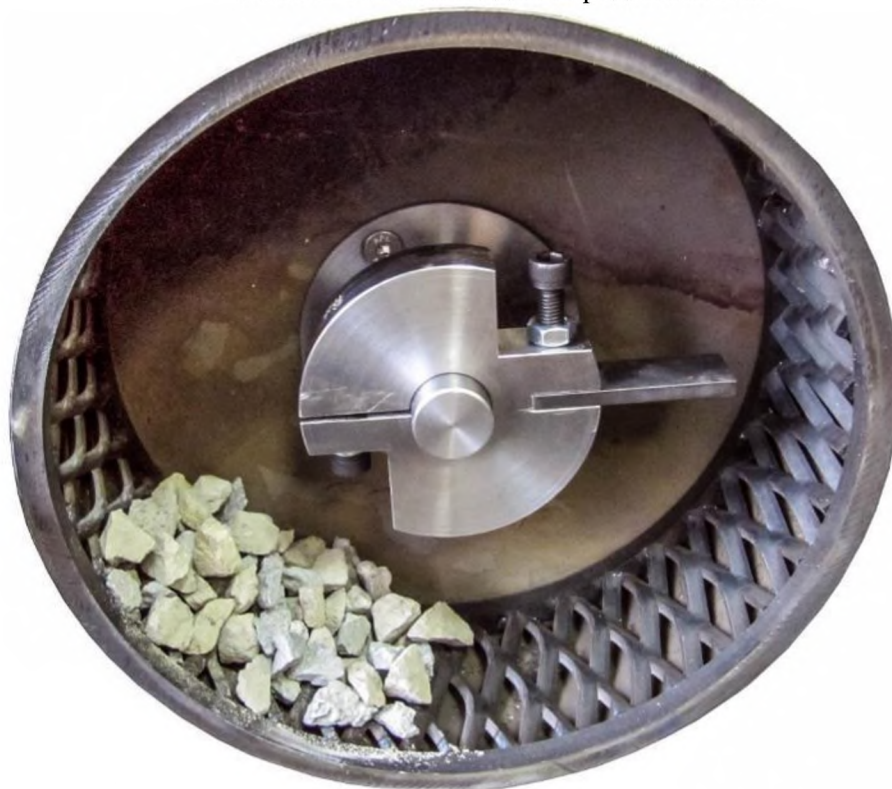
Рис.6.3. Стальная пластинка, закрепленная радиально на роторе
