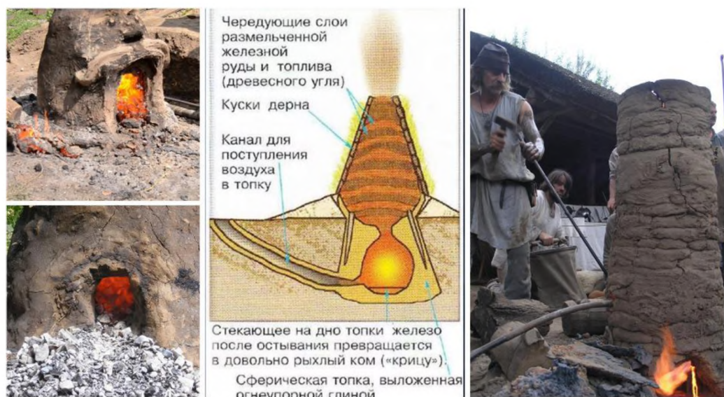
Рисунок 1.5 - Сыродутный процесс выплавки железа
