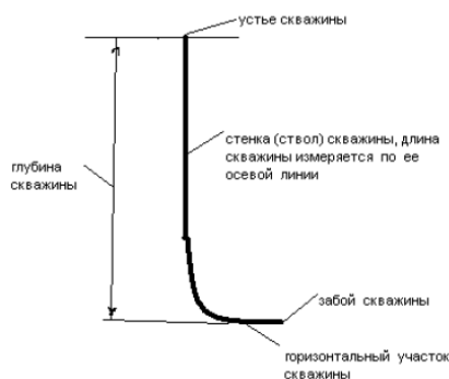
Рисунок 2.1 - Схема скважины и ее элементы
