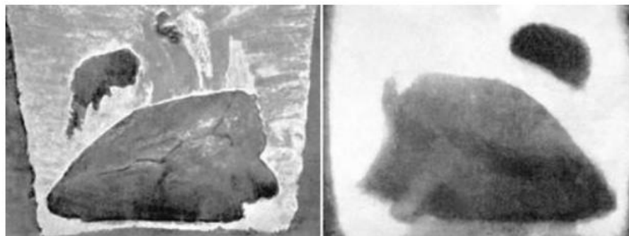
Рисунок 2. Снимок в гамма-излучении (слева) и фотография разреза прибыли (справа) слитка массой около 500 кг; видна усадочная раковина.
