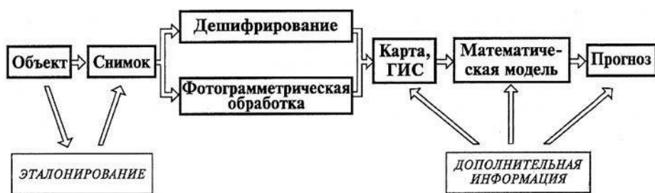
Принципиальная схема аэрокосмических исследований, показывающая основные технологические этапы и конечную цель
