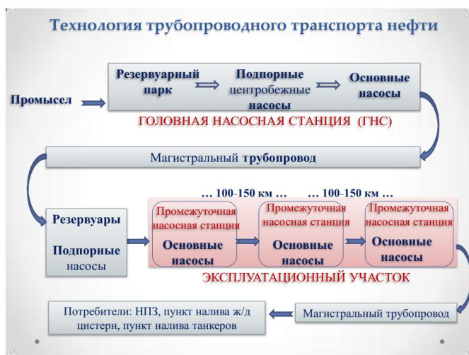
Рис. 2.2.2.1. Технология трубопроводного транспорта нефти
