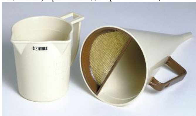
Рис.15. Вискозиметр «Воронка Марша»
