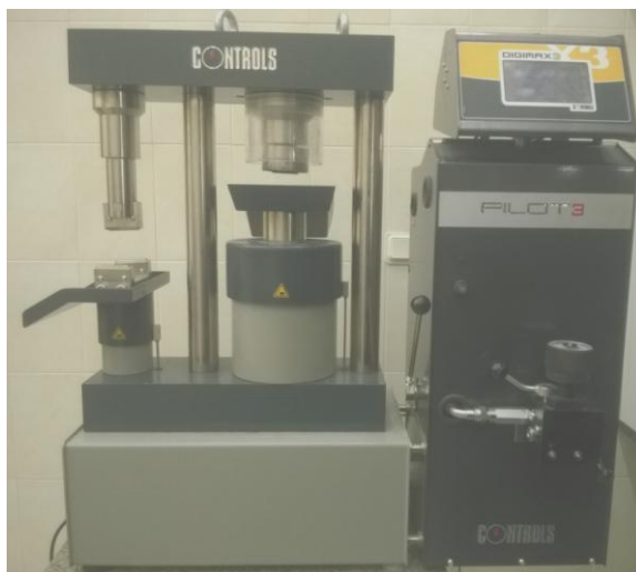
Рис. 39. Полуавтоматическая машина для испытания на сжатие и на изгиб Controls 65-L11G2/C Pilot 3
