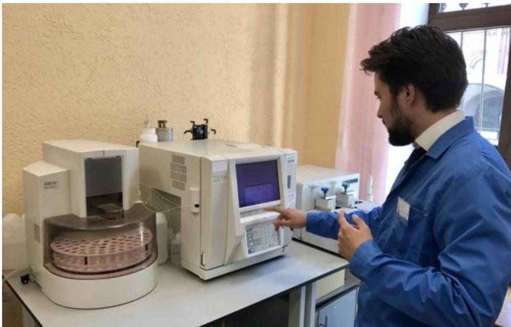
Рис. 1. Анализатор общего органического углерода и азота в лаборатории моделирования экологической обстановки ЦКП Санкт-Петербургского горного университета
