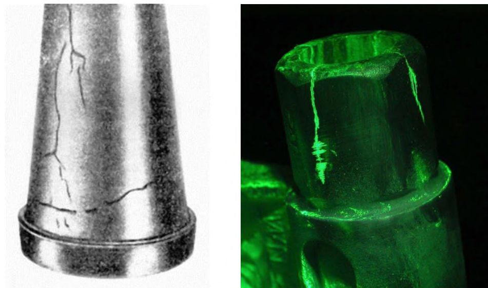
Рис. 15. Осадок магнитного порошка (из суспензии) на невидимых глазом закалочных трещинах в стальной детали.
