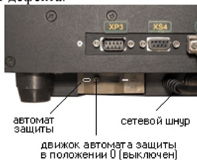
Рис. 3 - Автомат защиты демагнитизатора (в положении 0 – отключено)
