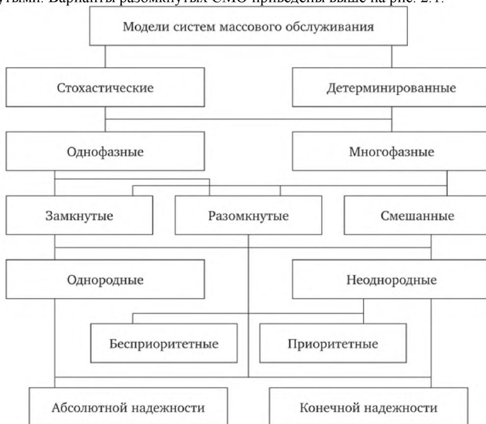
Рис. 2.2. Вариант классификации моделей систем массового обслуживания
