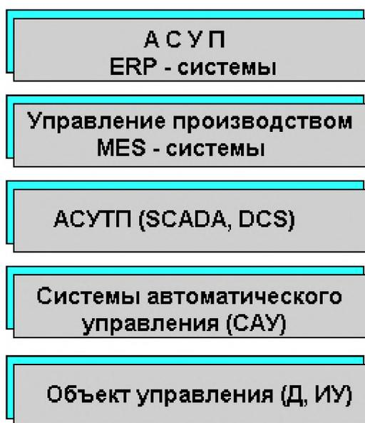
Отсюда следует, что интегрированную автоматизированную систему управления промышленным предприятием можно представить в виде четырех взаимосвязанных уровней управления (рис. слева).
