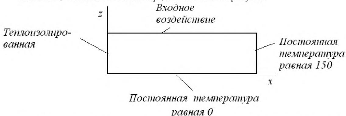
Представим входное воздействие на него в виде ряда Фурье по пространственной координате, в соответствии с указанными граничными условиями, и построим графики зависимостей амплитуды входного воздействия от координаты  $x$  (при  $0 \leq x \leq Lx$ , где  $Lx$  - длина объекта (области распределения входного воздействия) по 1ой, 2-ой, 3-ей, 4-ой и 5ой модам, а также их сумму.
