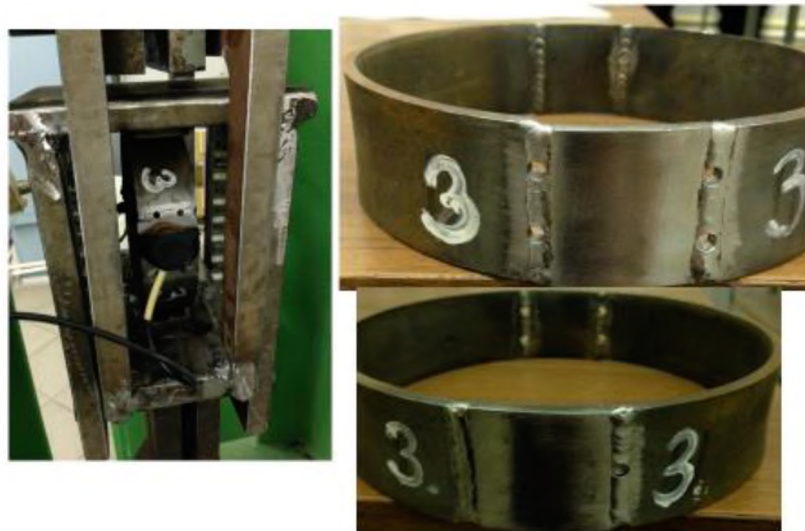
Рисунок 5 - Один из образцов сваренного встык кольца для АЭ испытания при одноосном сжатии (а) и его внешний вид при испытании (б).
